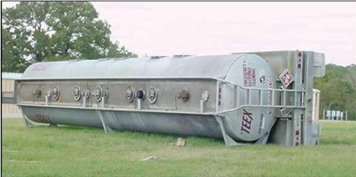
El etanol transportado en camiones cisterna se coloca y marca de la misma manera que todos los demás materiales peligrosos. Otras características de los camiones cisterna son los dispositivos de alivio de presión y vacío. Por lo general, se cargan y descargan en la parte inferior y están equipados con un sistema de recuperación de vapor.
